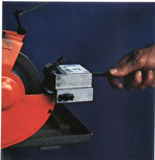
Le dresseur de membre SPRINTER est un accessoire facile d'utilisation. Il sert à régénérer la surface abrasive de tous les types de meules. Il est en aluminium, possède un guide en acier calibré et un diamant à réglage micrométrique de 030 KT (CARAS).
